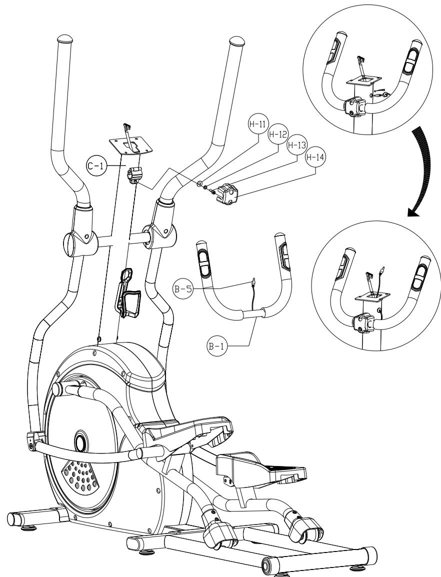
1. Закрепите передний руль (B-1) на стойке консоли (C-1) с помощью 1 шайбы (H-11), 1 шайбы (H-12) и 1 болта (H-13);
