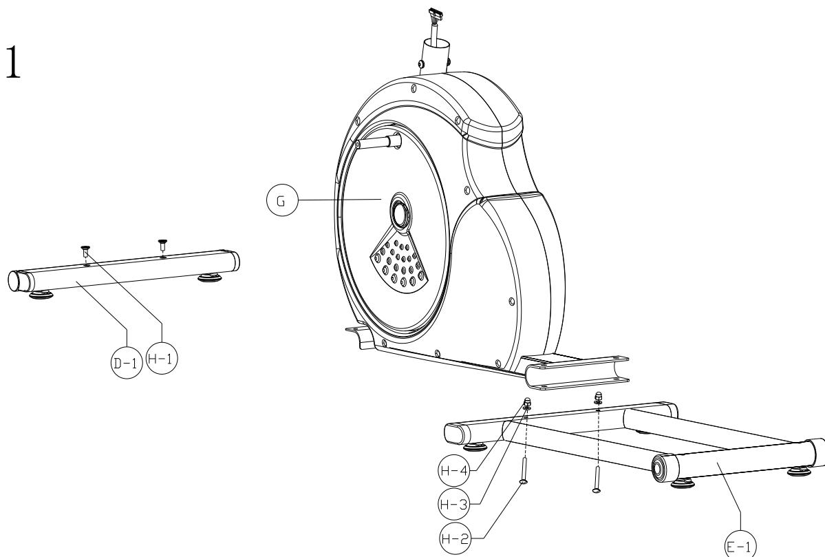
Закрепите переднюю опору (D-1) на основной раме с помощью болтов (H-1), затем закрепите заднюю опору (E-1) на основной раме, используя винты (H-2), шайбы (H-16) и гайки (H-4), как показано на рисунке.
