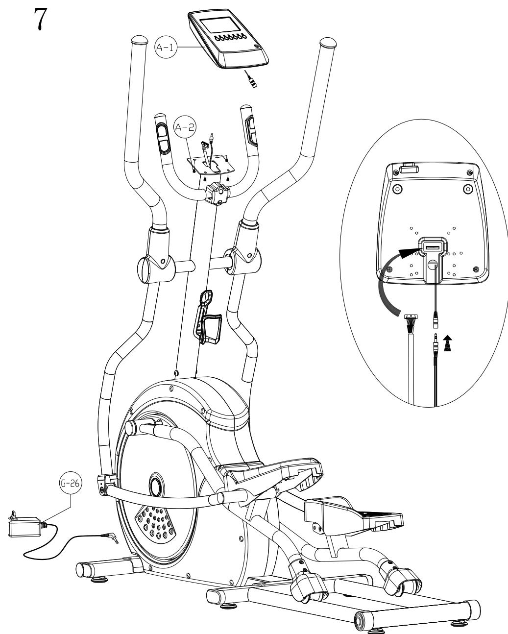
Подключите кабель пульсомера (С-2) и провод пульсомера (В-5) к консоли (А-1), затем закрепите ее на стойке винтами.
