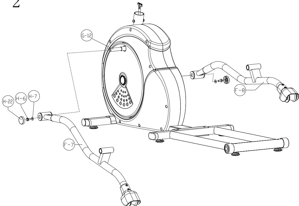
1. Закрепите левую опору педали (F-7) на диске(G-12), используя 1 шайбу (H-7), 1 винт (H-6) и 1 крышку (H-22);
