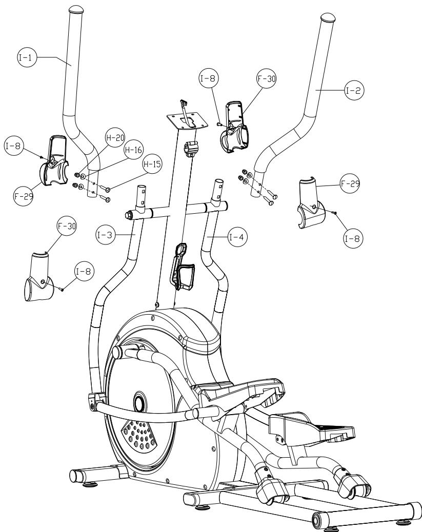
1. Соедините верхний левый руль (I-1) с нижним (I-3) с помощью 2 гаек (H-20), 2 шайб (H-3) и 2 винтов (H-15);
